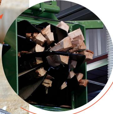
**2 Fendage :** passage des rondins dans une machine de fendage. Calibrage en petites sections de 15 cm maximum (longueur 25, 30 ou 40 cm).
